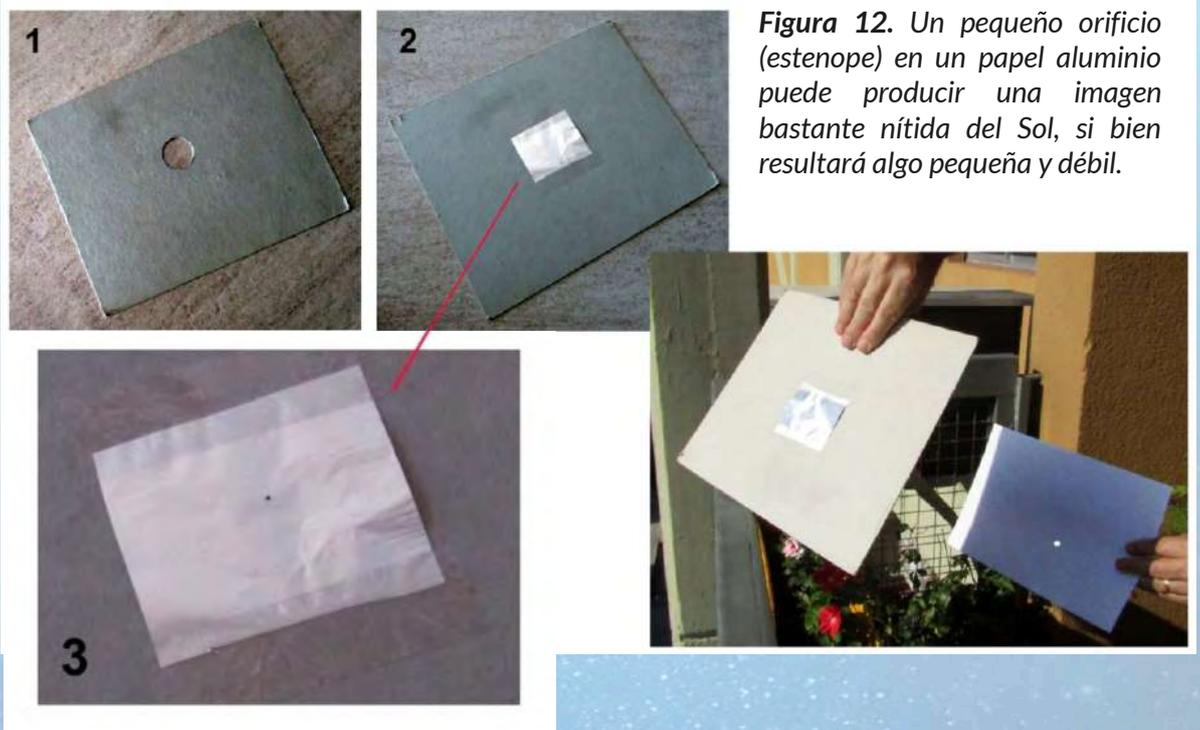
Figura 12. Un pequeño orificio (estenope) en un papel aluminio puede producir una imagen bastante nítida del Sol, si bien resultará algo pequeña y débil.
