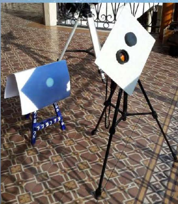
**Figura 17.** Binocular montado en un trípode dispuesto para proyectar la imagen del Sol, en oportunidad del tránsito de Mercurio del 9 de mayo de 2016. Uno de los objetivos está tapado y una hoja de cartón fue colocada al frente para proyectar la sombra necesaria para poder ver una imagen con buen contraste. El diámetro de la imagen del Sol para un instrumento dado, depende de la distancia a la que se coloca la pantalla, formada por una simple hoja blanca mate.
