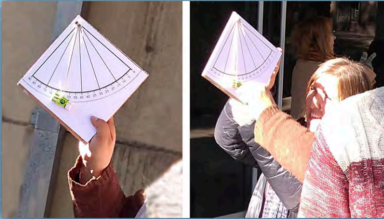
Figura 33. Cuadrante fabricado sobre un trozo cuadrado de madera, al que se le pegó un papel con el dibujo de un cuarto de circunferencia graduado. Una forma alternativa, es emplear un transportador (lo más grande posible). Un hilo al que se le ata un peso (en la figura una goma de borrar) define la vertical del lugar.
